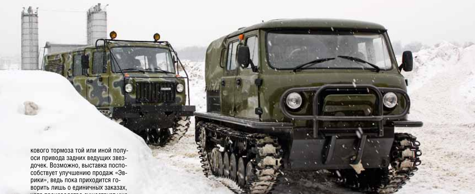
Завод вездеходных машин в Заволжье использует кузова уазиков при постройке своих машин, как, например, в случае с этим ЗВМ-3402 «Унжа»
